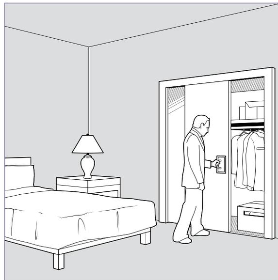
**Figure 9** : Les personnes dont la force et la dextérité manuelles sont diminuées peuvent plus facilement tirer sur une grosse poignée en D.
