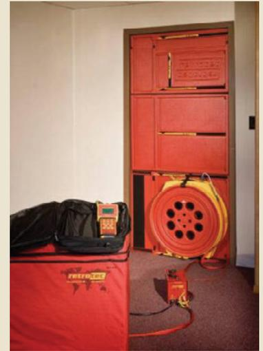
Figure 5.2 Installation d'un infiltromètre (image reproduite avec l'aimable autorisation de Retrotec Energy Innovations Inc., Vancouver).
