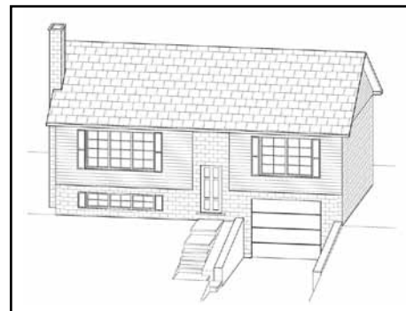
Figure 3 Garage en sous-sol
